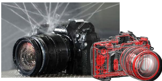
防滴試験の様子と各所に施された密封シーリング
